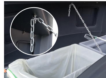
Kuva 12. Sivusaranan ketjun sekä kertakäyttöpussin asennus
